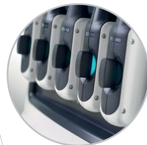
Бесштырьковый коннектор датчика со световым индикатором
